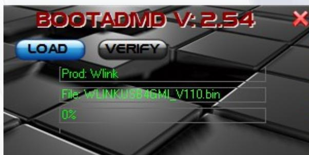
Lo normal es que se active el Boot en el Wlinkusb de forma automática. Si no fuera así o una de las cargas de firmware se hubiera quedado a medias, debe quitarlo del USB y volver a conectarlo, inmediatamente actualice y abra el puerto COM en la APP WlinkDemo.
