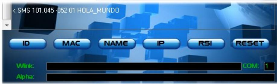
Averigüe la dirección IP del Wlink destino con el comando "ID", en el ejemplo será "111.142".
