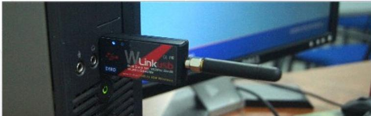
Para comunicarse con el Wlink a través de puerto serie en Windows, necesitara el hiperterminal a 115200b,8,N o el software WlinkDemo (solo Win7 u 8).
