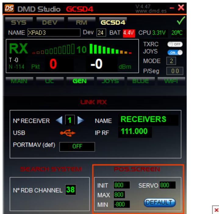
**INIT:** Configura inclinación inicial del servo (Por defecto: 780), puede ser igual al valor max.
