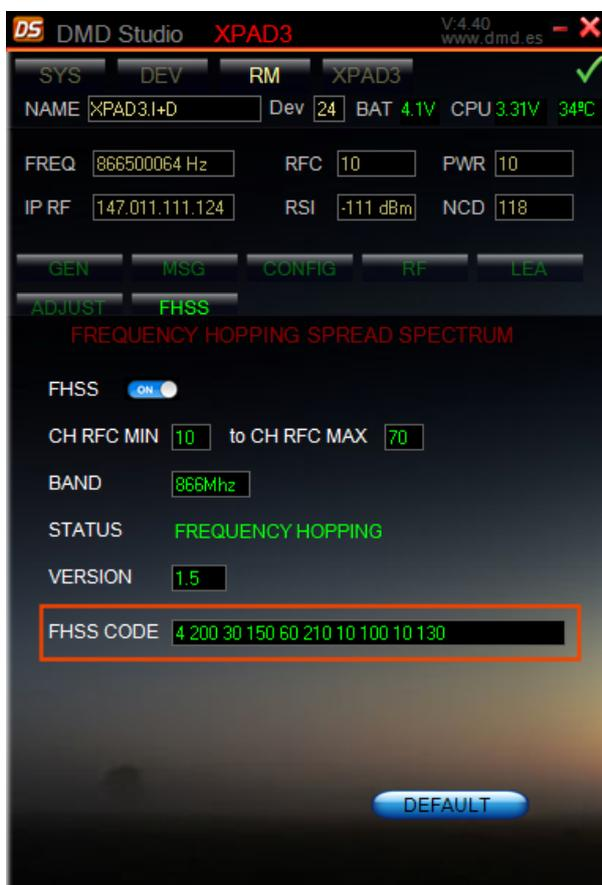
**Mejora:** El parámetro CH RFC MAX solo se podía configurar hasta canal 40, ahora se configura el canal máximo dependiendo de la frecuencia seleccionada 40, 80 o 255, para ver el canal máximo RF puede acceder a la pestaña **DS/RM/RF** (Parámetro RFCMAX).
