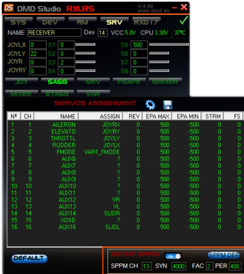
Ahora son configurables los datos SPPM, esto sirve en caso de necesidad, para utilizar los 16 servos disponibles. Por defecto con los tiempos estandar de servos (1.5mSeg/Neutro) como maximo se puede utilizar 13 servos. Para poder utilizar 16 (o mas en el futuro) se debe bajar el tiempo de sincronismo a 2000useg, FAC cambiarlo de 2 a 1 (750uSeg) y bajar PER a 200uSeg.
