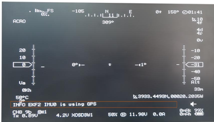
Visualización mensajes de alarmas y notificación Mavlink con 30 segundos de duración, se visualizan hasta 5 mensajes simultáneos entre telemetria Mavlink y telemetria XLRs.
