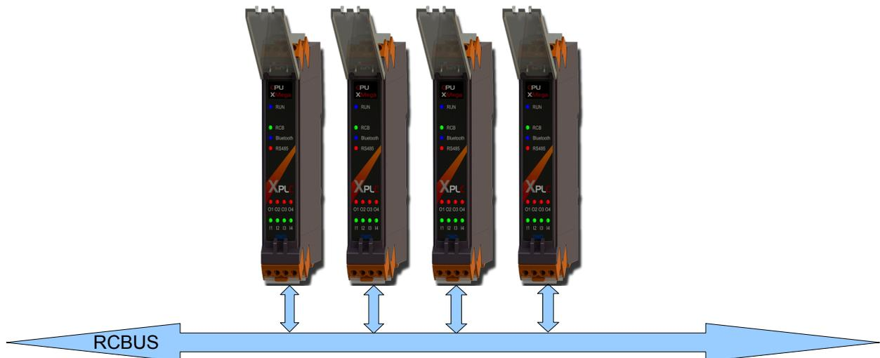
Los módulos con RS485, ethernet o Wireless-Unibus12w actúan como GateWays o Routers y pueden extender la red LAN de forma virtual a cualquier punto del planeta.
