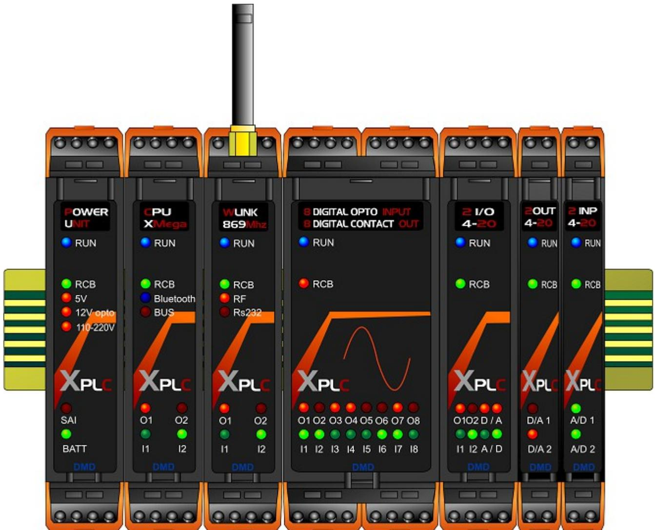
El XPLC se compone de diferentes módulos con inteligencia distribuida (Smart I/O Modules), es decir cada modulo dispone de un procesador independiente y una o varias interfaces de comunicaciones, para terminales o red.
